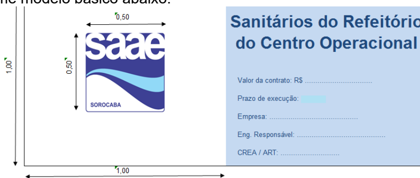
Figura 1: Placa de Identificação da Obra
