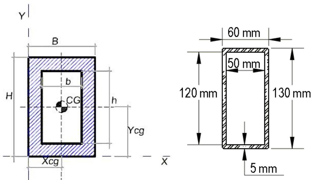
Figura 2 – Seção transversal do perfil
