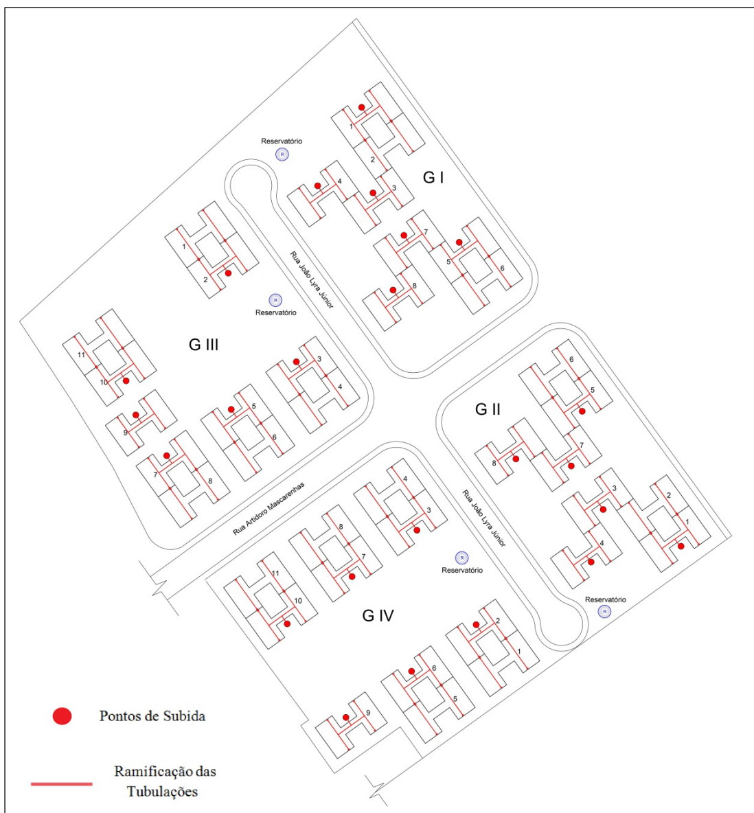
Figura 60 – Locação dos pontos de subida e tubulação de derivação dos blocos.
