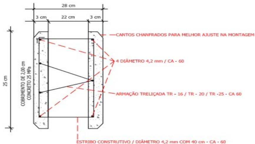
\* COMPRIMENTO DA PLACA DE CONCRETO - 2,50 m
