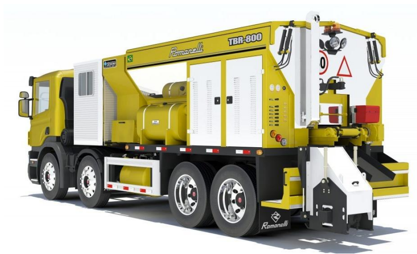
Caminhão com caçamba térmica.
