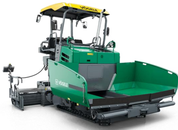
Vibro acabadora de asfaltos sobre esteiras.
